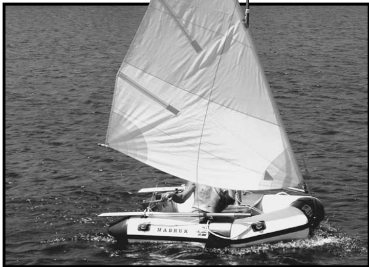
Una panca con due derive laterali, due timoni sullo specchio di poppa e un albero con antenna hanno trasformato un gommone di 2,10 m in un tender a vela sicuro e manovriero.
