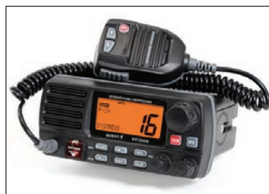
1 - Apparecchio radio Vhf fisso. I suoi principali comandi sono: la manopola di accensione e regolazione del volume, il tasto di trasmissione posto sul microfono, il selettore dei canali e la manopola del filtro antirumore di fondo ( squelch ).
