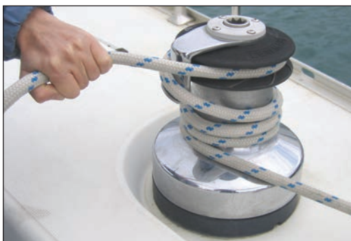
2 - Scotta del genoa data volta correttamente al winch.
