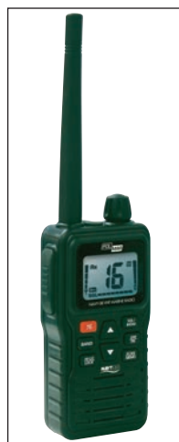
3 - Apparecchio radio Vhf portatile. La sua portata massima difficilmente supera le 3-4 miglia mentre per gli apparecchi fissi è mediamente intorno alle 20-40 miglia.
