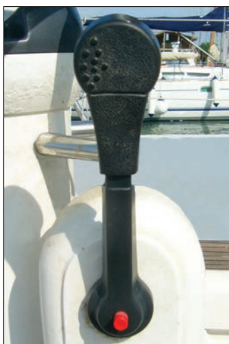
1 - Tipica manetta di una barca da crociera. È in posizione verticale, neutra.
