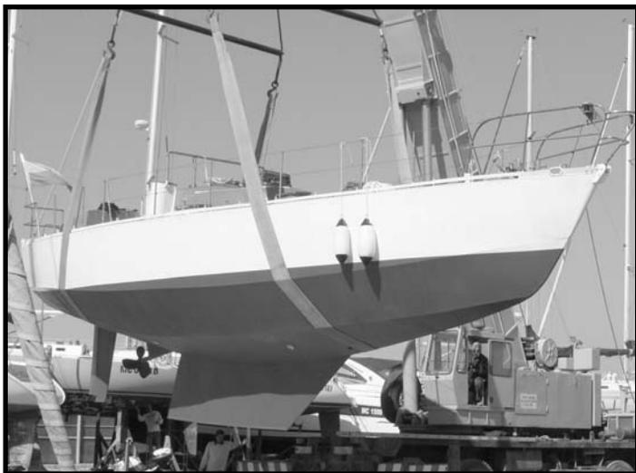
Lo sloop **Piccola** è interamente in ferro. È lungo 13,60 m, largo 4 e pesa 12 tonnellate. È stato costruito in ogni sua componente da una sola persona in 1.500 ore di lavoro.
