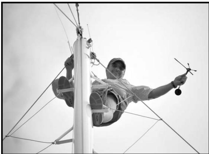
*Discutibili esteticamente, i gradini sull'albero della barca sono sicuramente il modo migliore per salire in maniera comoda e sicura, per effettuare ispezioni o manutenzioni.*
