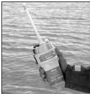
La radioboa va programmata con un codice (Mmsi) identificativo a 9 cifre.
