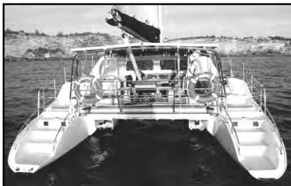
Il catamarano ha una coppia di fuoribordo da 9.9 hp installati in appositi alloggi sotto le sedute del timoniere.
