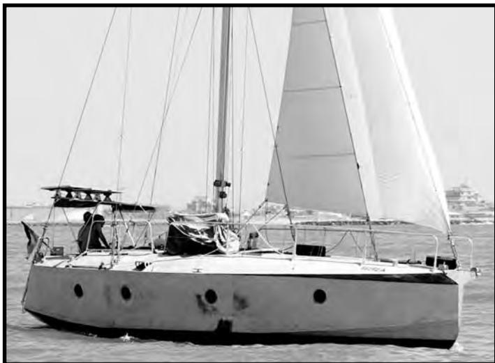
*L'ultima realizzazione di Ernesto Tross è l'Orso Bianco (9,98 m), una barca in alluminio, a deriva mobile, inaffondabile e armata con un albero senza randa, ma solo con fiocchi.*
